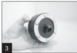
3 Mit Werkzeug abgewinkelte Lamelle zur anderen Seite durchdrücken.
