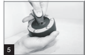
5 Lamelle nach dem Lösen von den anderen Lamellen abziehen.
