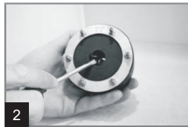
2 Innerste Lamelle mit Werkzeug (z. B. Schraubendreher) von den anderen Lamellen abwinkeln.
